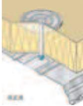
la solution par excellence lorsqu'il s'agit d'un système de fixation dont on ne souhaite pas voir une vis au travers du bac acier. La combinaison Rondelle/Plaquette + Entretoise + Rivet offre une fixation discrète grâce au fût laqué du rivet (Idéal pour showrooms, magasins, halls de sports et locaux publics...)
